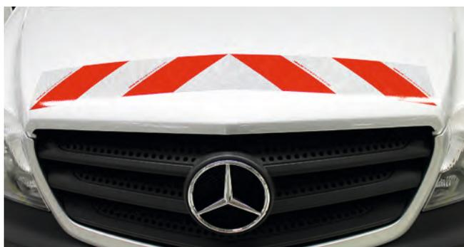
Außerdem müssen die Fahrzeuge mit einer rotweißen Warnmarkierung (Sicherheitskennzeichnung), die dem Normblatt DIN 30710 entsprechen, gekennzeichnet sein. Bei allen anderen Fahrzeugen gilt: Die Rundumleuchte ist nicht zugelassen.
