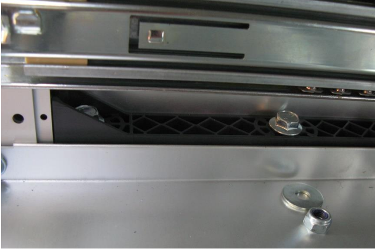
Abbildung 6.9.5.: Verschraubung anziehen mit Ratsche mit Drehmomenteinstellung.
