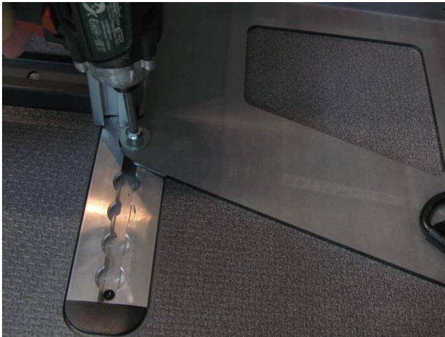
Abbildung 5.4.4.: Verschraubung Bodenhalter hinten.
