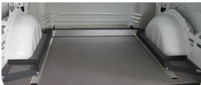
Abbildung 4.3.9.: Unterkonstruktion lose vormontiert
