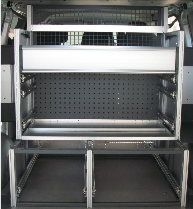
Abbildung 6.6.5.: Einrichtung im Fahrzeug am Leergehäuse ausgerichtet.
