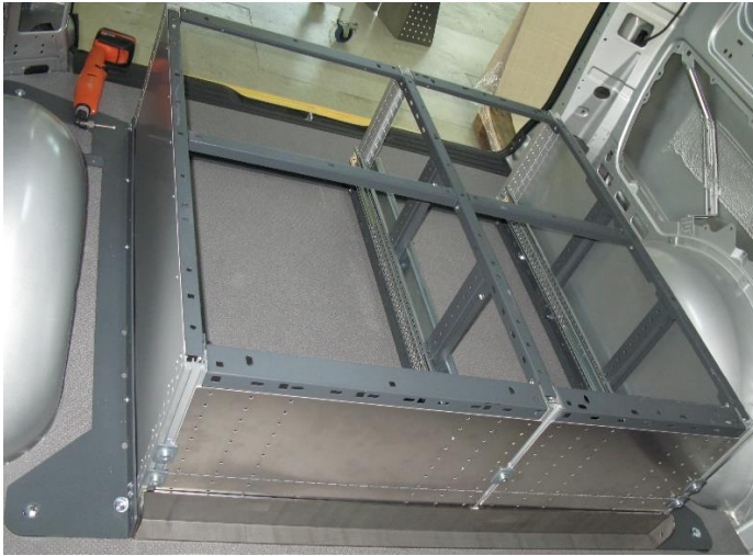
Abbildung 5.3.3.: Unterkonstruktion mit Unterflurmodul
