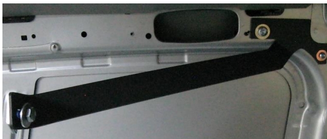
Abbildung 6.5.7.: Wandanbindung oben links mit vormontiertem Befestigungsmaterial
