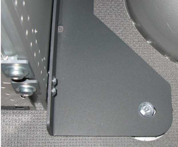
Abbildung 5.4.3.: Verschraubung der Bodenhalter
